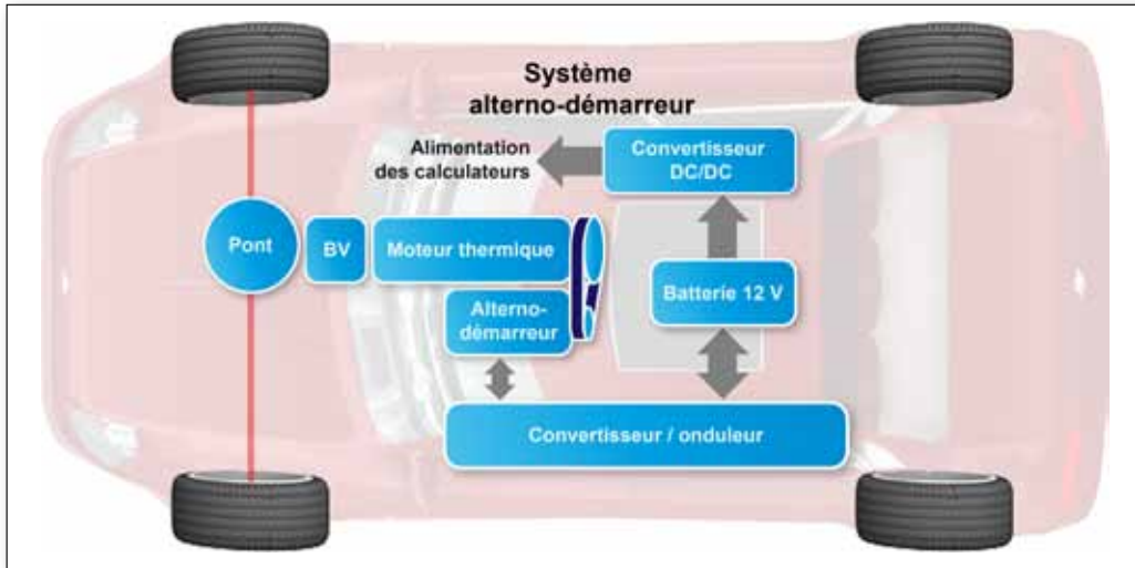
Synoptique d'un véhicule micro-hybride
